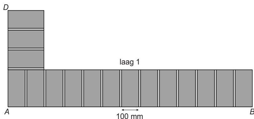
Hierboven zie je een schets van het bovenaanzicht van de onderste laag bakstenen van het muurtje (laag 1).
